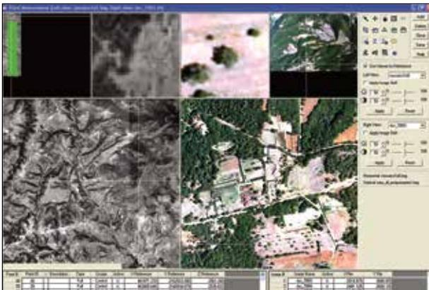
Figura 11. Obtención de puntos de control terrestre. En la parte izquierda se encuentra la cartografía base y en el lado derecho la imagen donde se están marcando los puntos.
