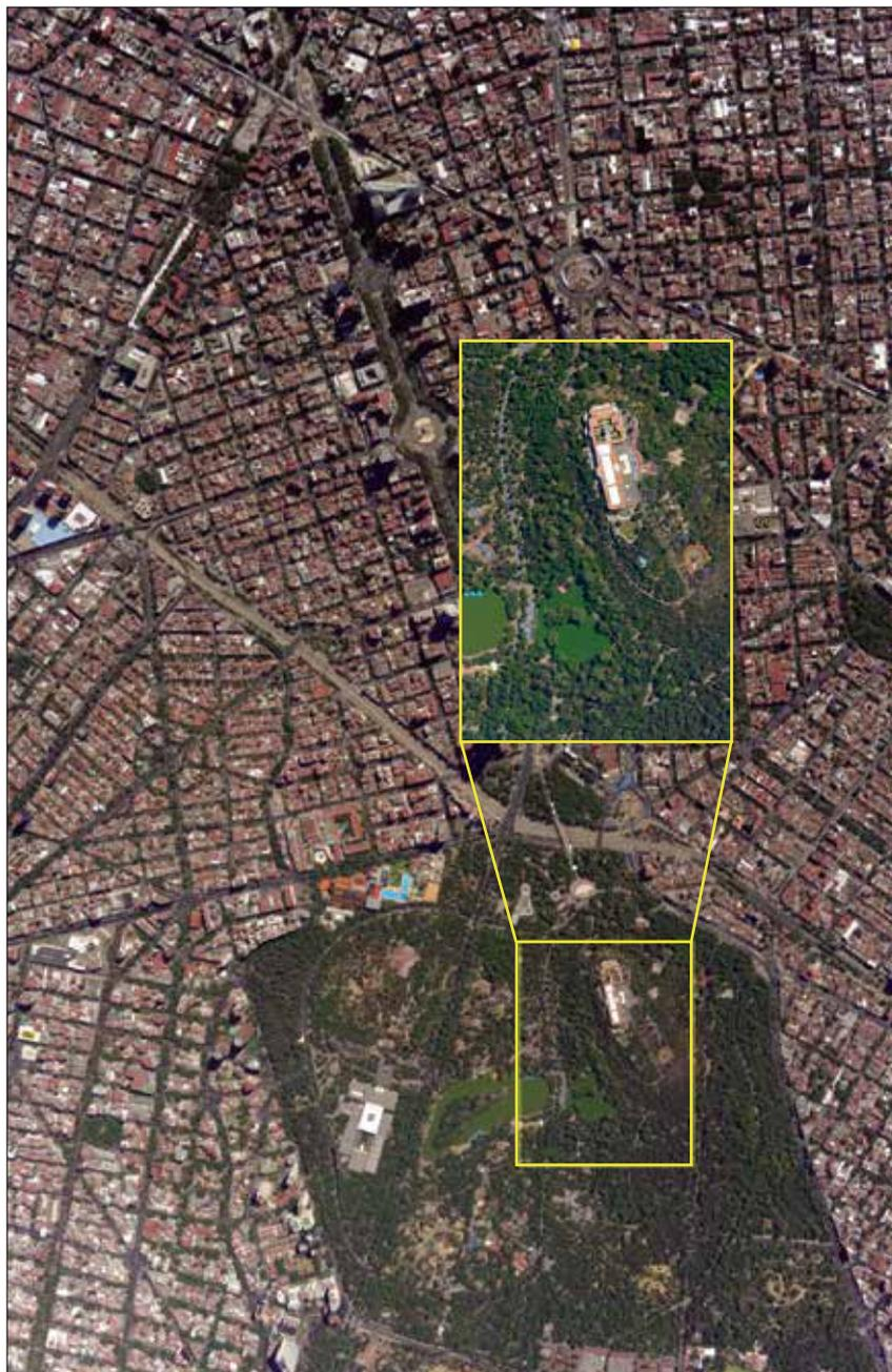
Figura 1. Ejemplo de una imagen obtenida con una cámara Nikon D3x, que tiene una cobertura de 4x3 km, con tamaño de píxel de 0.6 m.
