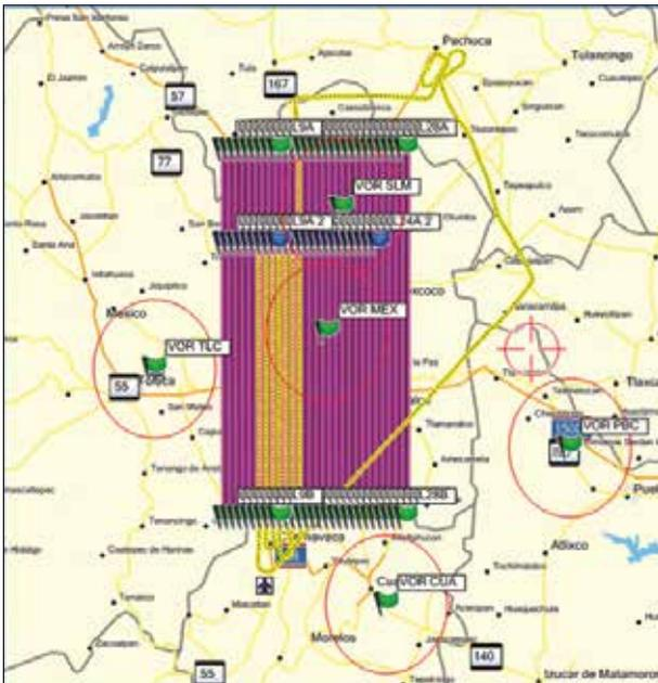
Figura 6. Visualización del proyecto con el programa Map Source, donde se aprecia el plan de vuelo completo y las líneas que ya han sido cubiertas en una primera etapa de trabajo.
