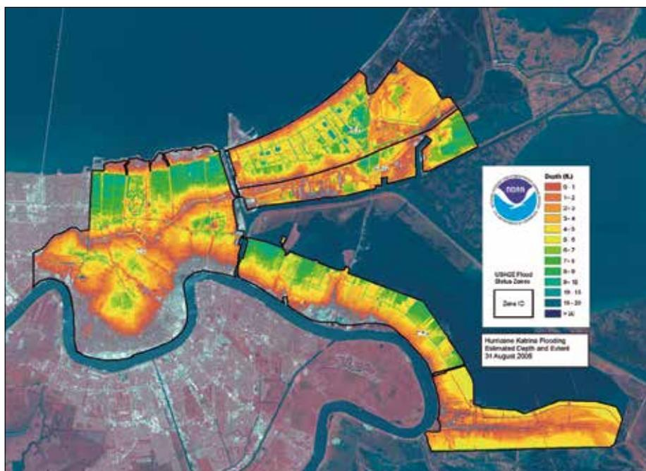
Figura 2. Estimación de la profundidad de inundación con base en un modelo digital del terreno de 10 m de resolución en un sector de Nuevo Orleans a consecuencia del huracán Katrina (fuente: [http://www.esri.com/disaster\\_response/hurricanes/graphics/katrina/katrina\\_est\\_water\\_depth\\_lg.jpg](http://www.esri.com/disaster_response/hurricanes/graphics/katrina/katrina_est_water_depth_lg.jpg)).
