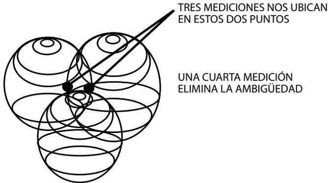
Figura 4. Trilateración, determinación de la posición a partir de la intersección de tres esferas (fuente: LAGE, Instituto de Geografía, UNAM).
